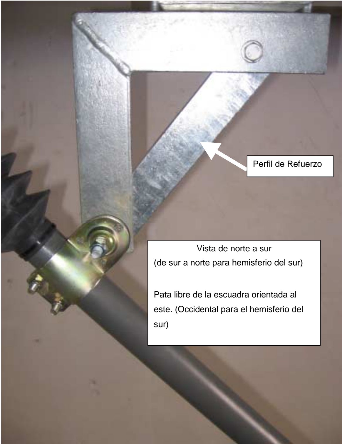
Fig. 5.4 Montaje de la fijación inferior del motor
